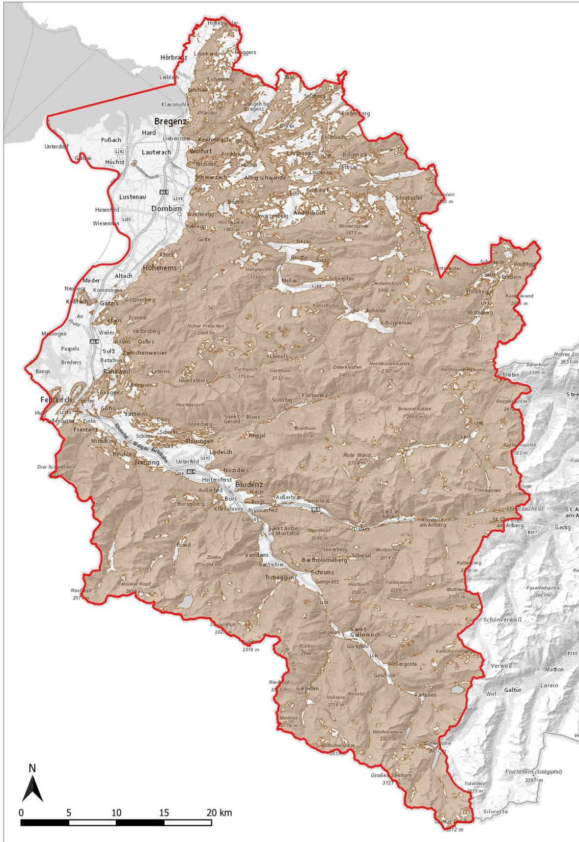
Abb 9: Flächen in Vorarlberg mit einer Hangneigung größer als 15°. Teilflächen welche dieses Kriterium unterschreiten, aber weniger als 10 ha umfassen, wurden nicht berücksichtigt [Hintergrundkarte: basemap.at].
